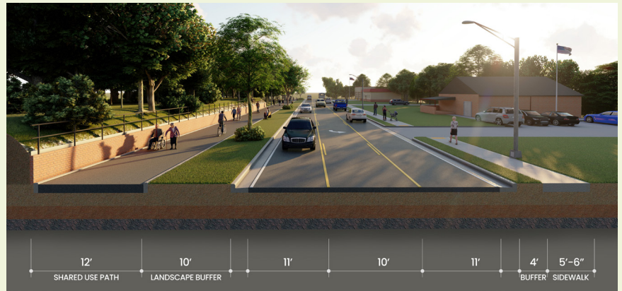
Sección típica de la College Street propuesta justo al sur de la intersección de N. Green Street, orientada al sur
